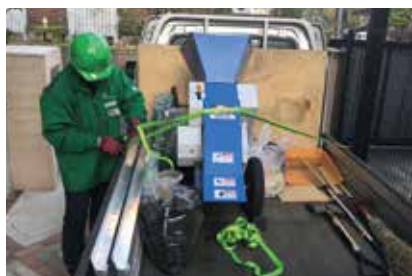
チップパー(写真中央) 剪定した枝葉を細かく砕く機械です
