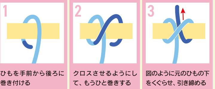
**POINT** ・最後にひもの先端を片蝶結びすると、より強度が高まる
